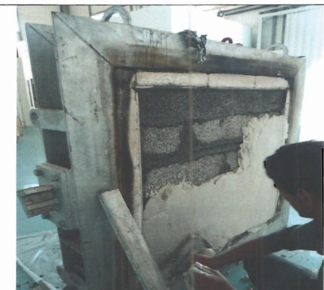
شکل ۴: اجرای آندود گچ به ضخامت ۱/۶ سانتی‌متر در روی دیوار
